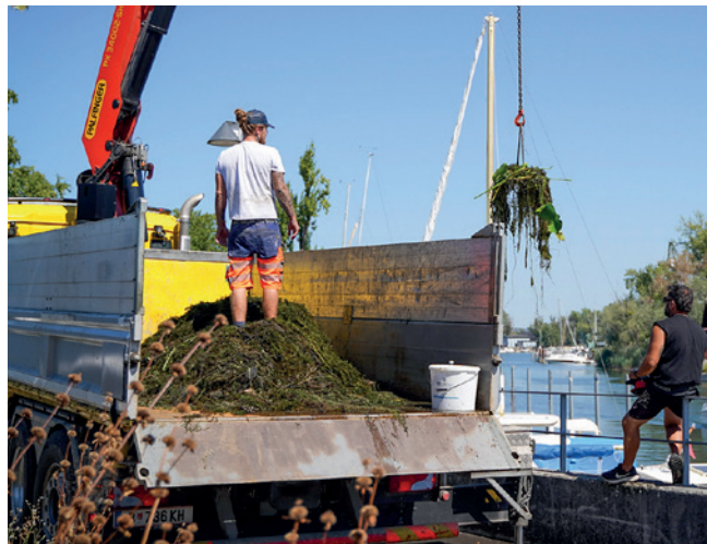
Bei den Bootliegeplätzen kam ein selbst konstruierter und am Greifarm eines Lkw befestigter Rechen zum Einsatz.
